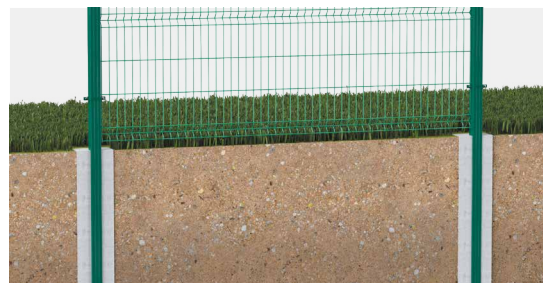
МОНТАЖ С БЕТОНИРОВАНИЕМ СТОЛБОВ
